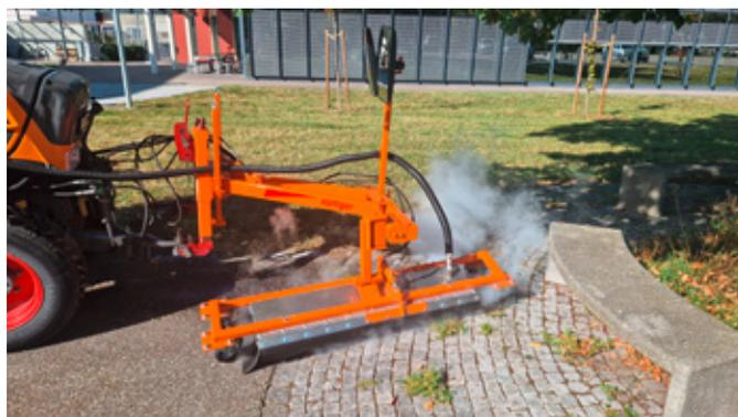
Das Anbaugerät für den bestehenden Traktor arbeitet mit bis zu 180°C heissem Wasserdampf. Dadurch wird beim Unkraut ein Eiweisschock ausgelöst, der die Zellen der Pflanze beschädigt. Folglich kann die Pflanze kein Wasser mehr aufnehmen und vertrocknet. Der ganze Prozess funktioniert ohne jeglichen Einsatz chemischer Zusatzmittel.
